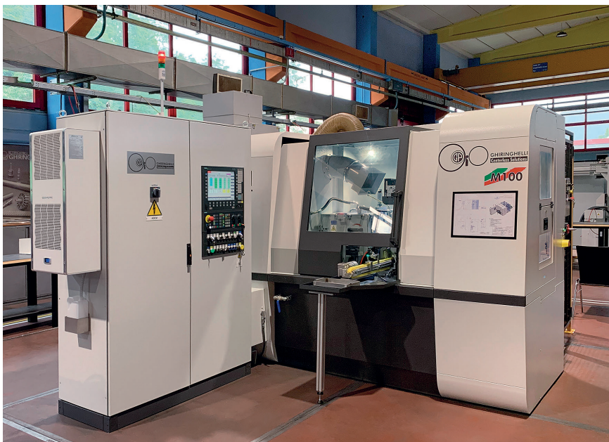
1 Aus der breiten Palette an spitzenlosen Rundschleifmaschinen der Ausführung M100 von Ghiringhelli lassen sich vielfältige technologischen Lösungen für das hochgenaue Einstechschleifen gestalten © Ghiringhelli
